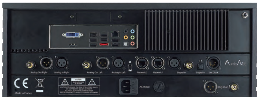
La sortie « Dig Out » permet de véhiculer le flux numérique vers le processeur des enceintes actives Answer quand celles-ci sont utilisées.
