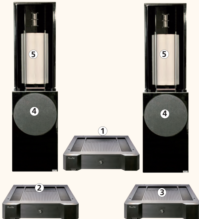
Configuration du système écouté avec, au centre (1), le processeur DSPV2 qui distribue les plages de fréquences analogiques de grave et d'aiguë respectivement (2/3) aux amplificateurs stéréophoniques AA2, qui eux-mêmes attaquent indépendamment par leurs canaux droit et gauche, la section grave (4) et médium-aiguë (5) des enceintes Response V2.
